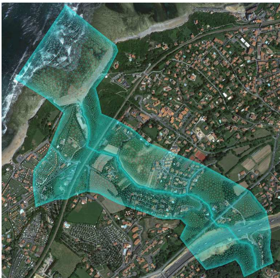
Figure 6 : Maillage du modèle hydraulique 2D du Baldareta
