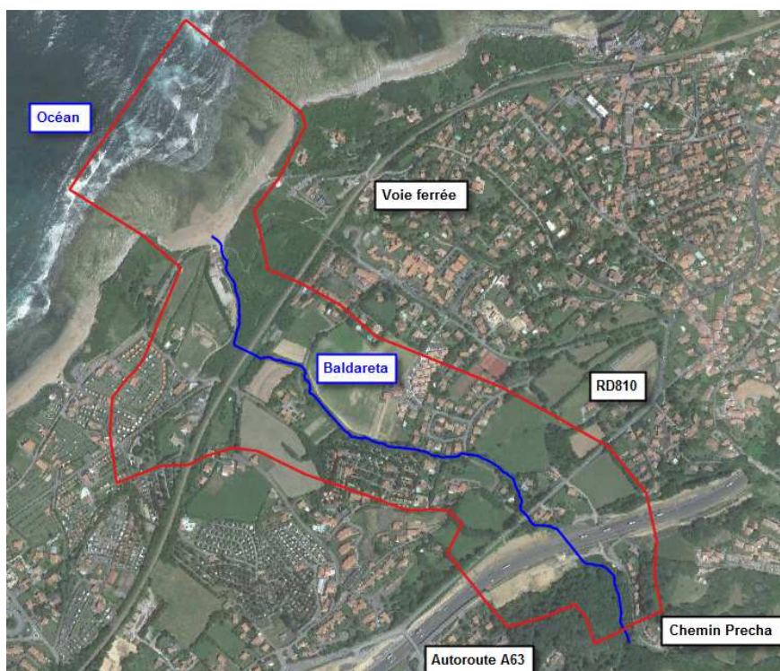
Figure 2 : Emprise du modèle TELEMACH-2D du Baldareta (en rouge)
